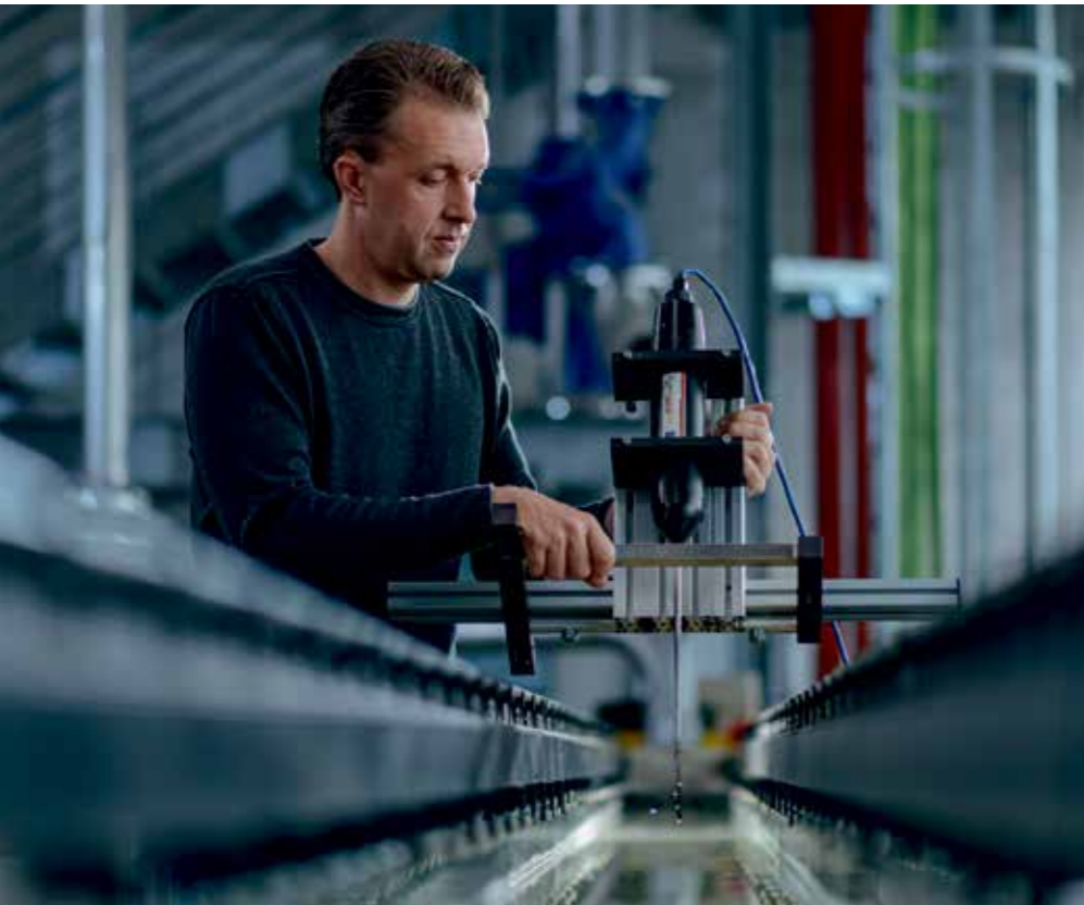
Gute Voraussetzungen für die Bearbeitung seiner Promotion bietet dem Doktoranden Daniel Hesse die wasserbauliche Versuchshalle des Fachbereiches Wasser, Umwelt, Bau und Sicherheit. An einer Versuchsrinne kann er mit entsprechender Messtechnik die Prozesse zum Sedimenttransport untersuchen.
