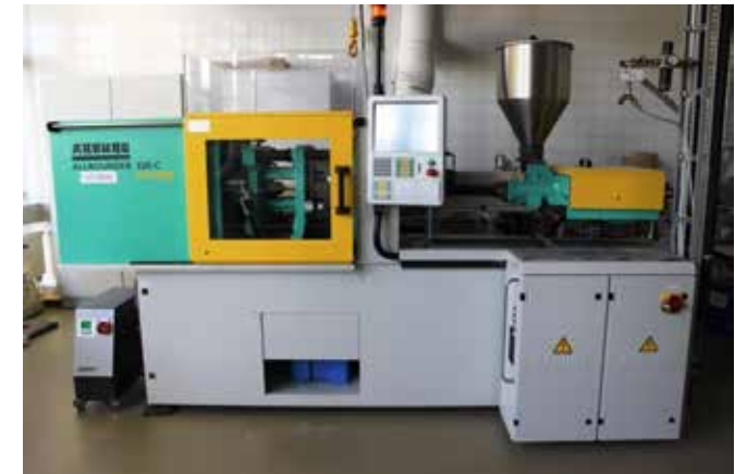
Abb. Hydraulische Spritzgussmaschine
