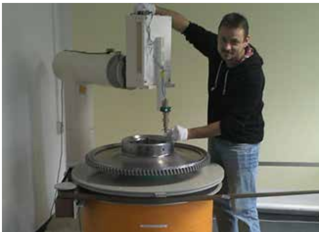
Abb. links Messaufbau zur Überprüfung von Flugturbinenscheiben
