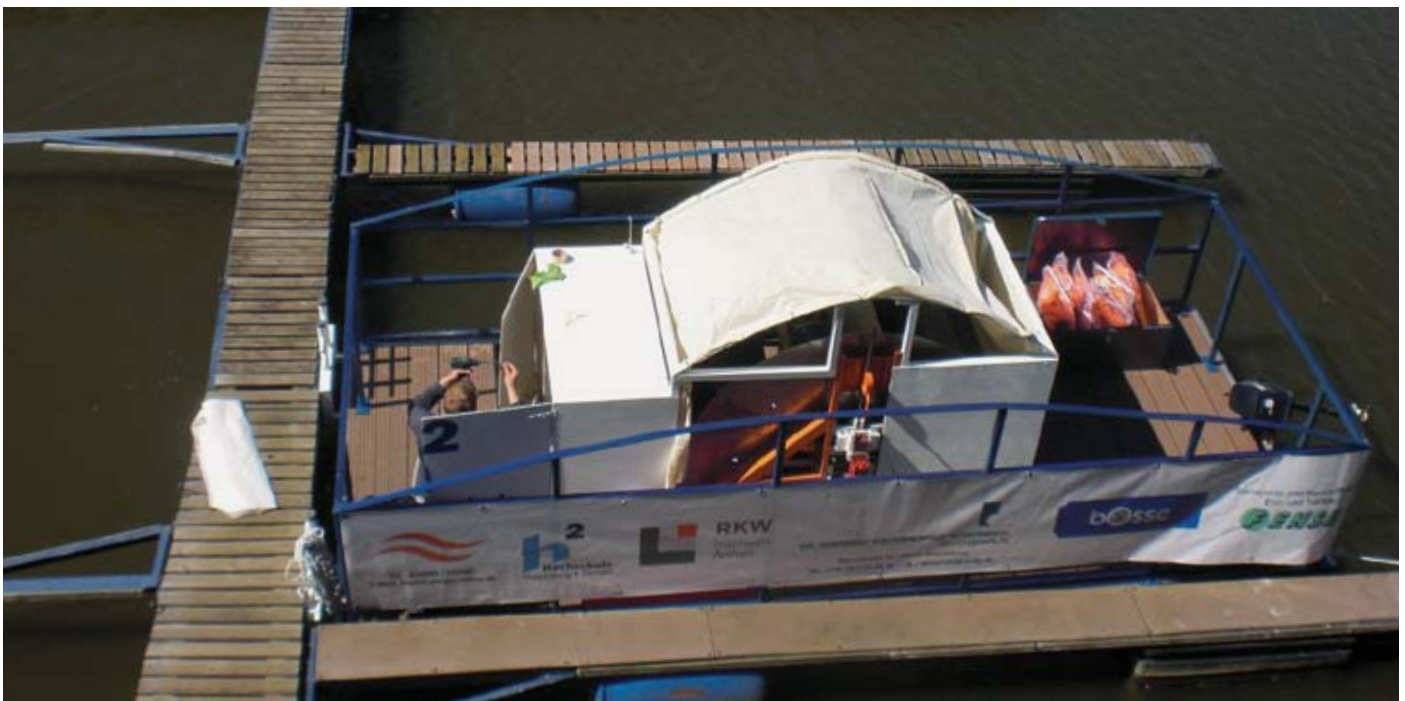
Allein auf der Basis von Wasserkraft kann die Anlage der Projektgruppe 1.500 Liter Trinkwasser aus Flüssen gewinnen.
