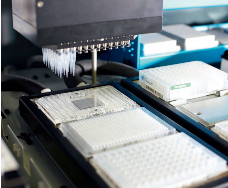
Im DKMS-Life-Science-Labor werden Liquid-Handler-Roboter zur Typisierung eingesetzt.
