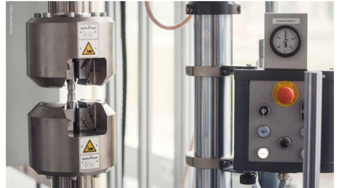
Eine Metallprobe wird zur Untersuchung in die servohydraulische Universalprüfmaschine eingespannt und um ihre eigene Achse gedreht.
