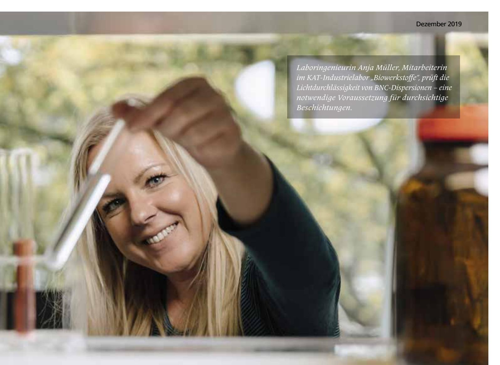
*Laboringenieurin Anja Müller, Mitarbeiterin im KAT-Industrielabor „Biowerkstoffe“, prüft die Lichtdurchlässigkeit von BNC-Dispersionen – eine notwendige Voraussetzung für durchsichtige Beschichtungen.*
