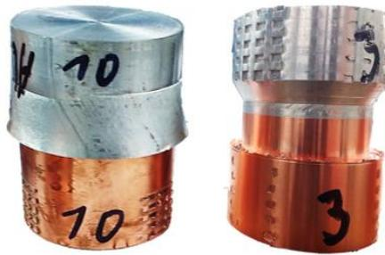
Bild 10: Schweißergebnis und Probenbild nach Torsionstest des zielführenden Parametersatzes Cu ETP – Al99,5 d60 mm
