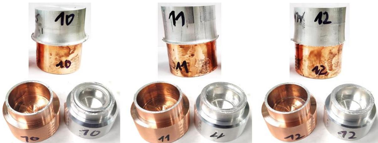
Bild 8: Schweißergebnisse und Bruchbilder der zielführenden Parametersätze Cu-ETP – AlMgSi0,5 d60 mm
