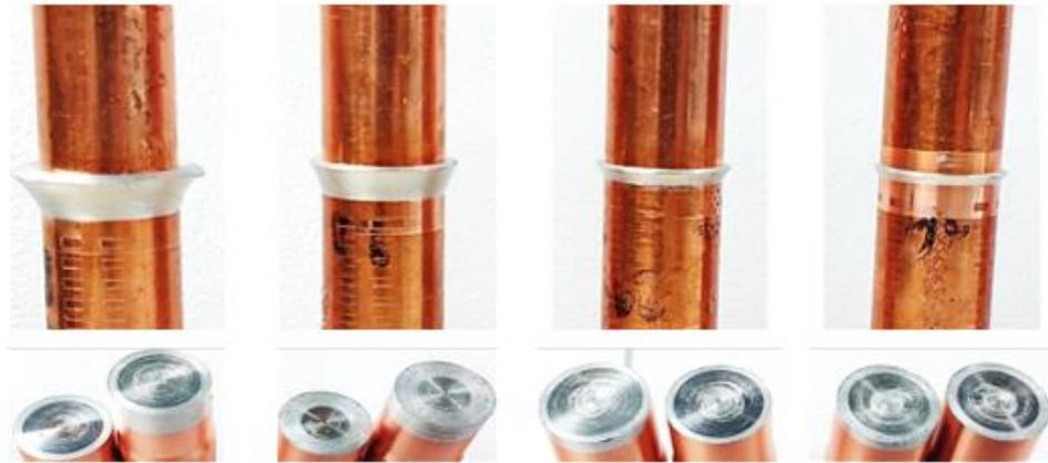
Bild 11: Schweißergebnisse und Bruchbilder der Schweißungen Cu-ETP mit Al99,5 Zwischenschicht d20 mm
