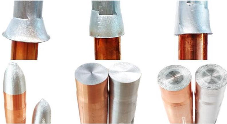
Bild 9: Schweißergebnisse und Bruchbilder der zielführenden Parametersätze
