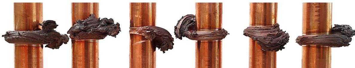
Bild 1: Schweißergebnisse Cu-ETP artgleich d20 mm
