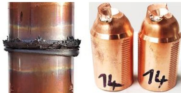
Bild 4: Schweißergebnis und Bruchbild des zielführenden Parametersatzes CuCr1Zr artgleich d35 mm
