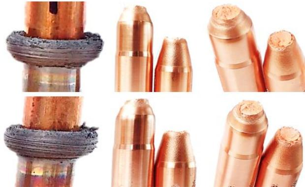
Bild 5: Schweißergebnisse und Bruchbilder der zielführenden Parametersätze Cu-ETP - CuCr1Zr d20 mm
