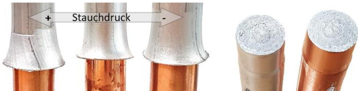
Bild 7: Schweißergebnisse und Bruchbild der zielführenden Parametersätze Cu-ETP – AlMgSi0,5 d20 mm
