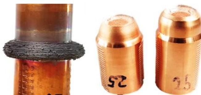
Bild 6: Schweißergebnis und Bruchbild des zielführenden Parametersatzes Cu-ETP - CuCr1Zr d35 mm
