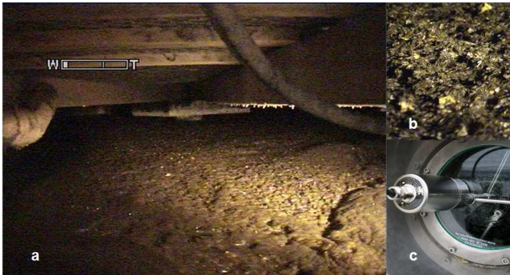
Abb. 10.21: Überwachung der Fermenteroberfläche mit Hilfe einer Ex-Zonen-Videokamera (c) mit Weitwinkel-Funktion (a) und Zoom-Funktion (b) (Wiese et al. [2008B])
