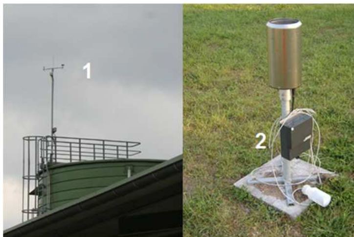
Abb. 3.42: Wettermessgeräte: 1 = stationäre Wetterstation auf dem Lagerbehälter einer Biogasanlage, 2 = Niederschlagsmessung
