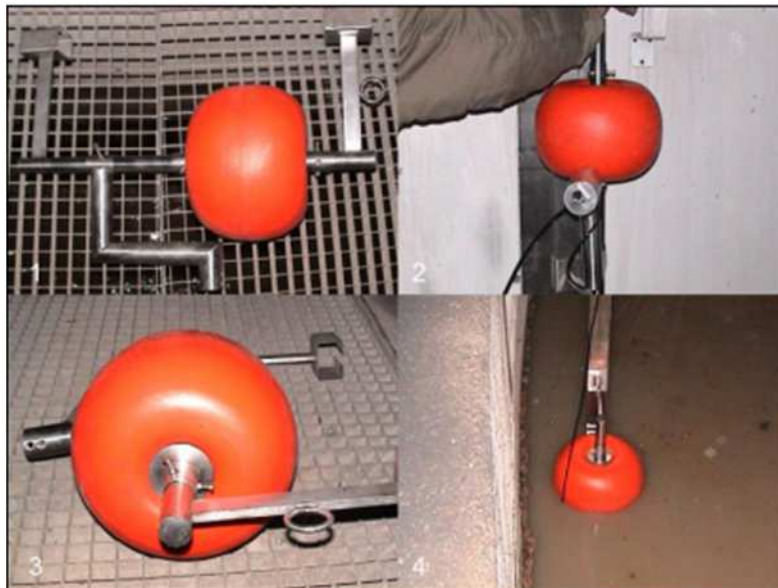
Abb. 3.26: Schwimmbojenlösung zur Montage von in-situ-Sonden (Bildquelle: Hach Lange)
