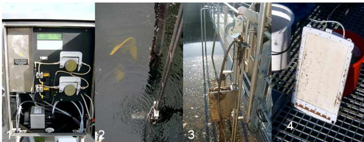
Abb. 3.21: Membranfiltration in einem SB-Reaktor als Probennehmergerät: Steuergerät mit zwei Schlauchmotorpumpen und Kompressor (1), Schlitten für den Filtermodulträger bei maximaler Absenkung (2), Schlitten in der oberen Endlage zwecks Reinigung der Filtermodule (3), Filtermodul (4) (Fa. Hach Lange) (Bildquellen: Autor)
