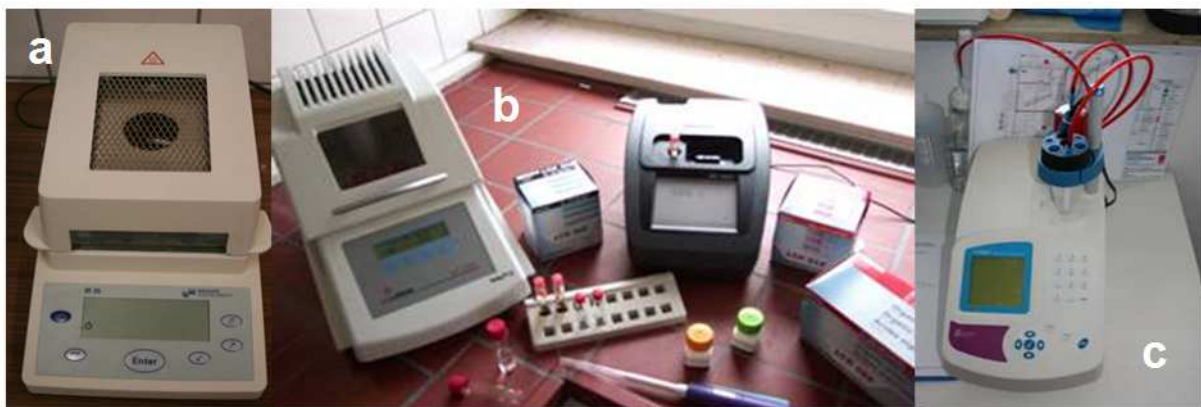
Abb. 3.44: Auswahl von Labormessgeräten auf Biogasanlagen: Automatischer Feuchtebestimmer (Fa. Denver Instruments) (a), Photometerarbeitsplatz (Fa. Hach Lange) (b) und automatischen FOS/TAC-Titrator (Fa. Hach Lange) (c) (Bildquellen: Autor)
