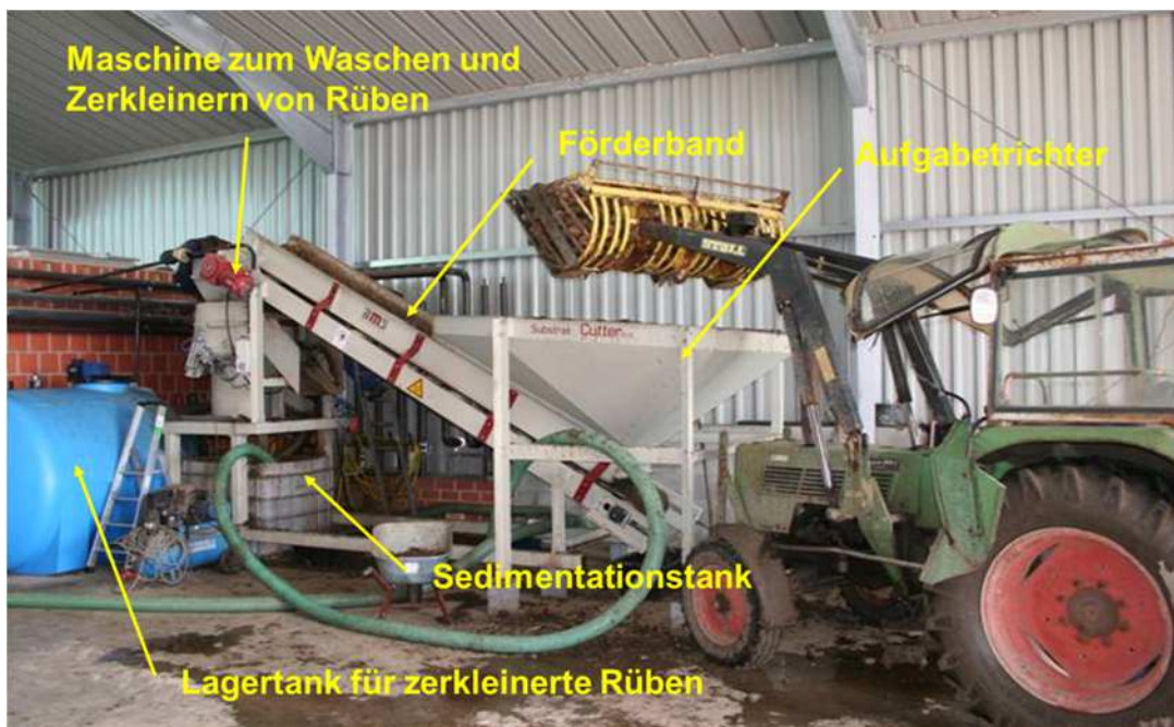
Abb. 10.8: Wasch- und Zerkleinerungsmaschine für Zucker-, Futterrüben o. ä. (Bildquelle: Wiese und Kujawski [2007] )
