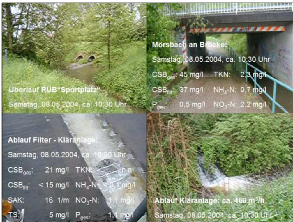
Abb. 7.17: Ergebnisse der händischen Beprobung an den Messstellen „Mörsbachbrücke“ und „Ablauf des Flächenfilters“ (Quelle: Wiese [2005] )
