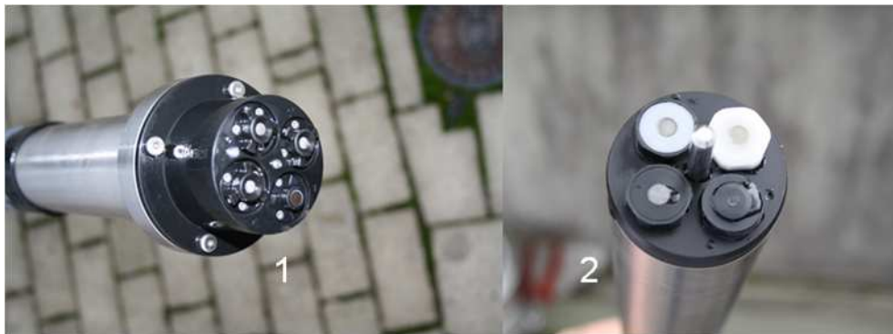
Abb. 3.8: Ionenselektive Kombielektroden für \text{NH}_4\text{-N} und \text{NO}_3\text{-N} (1 = AN-ISE der Fa. Hach Lange [2011A], 2 = Typ „Varion Plus 700 IQ“ der Fa. WTW [2011A]). Deutlich erkenntbar sind bei beiden Sensoren die verschiedenen Elektroden (Referenz-, \text{NH}_4\text{-N} - und \text{NO}_3\text{-N} -Elektrode, Störionenkompensation) (Bildquelle: Autor)
