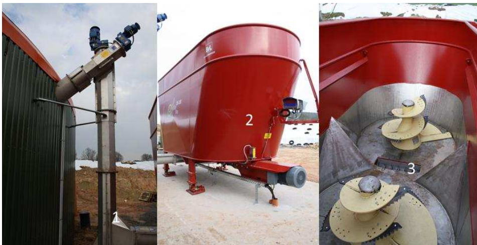
Abb. 8.6: Feststoffdosierer mit einem Futtermischer: (1) vertikale Transportschnecke mit Stopfschnecke, (2) Futtermischwagen, (3) Mischeinrichtung (Bildquellen: Autor)
