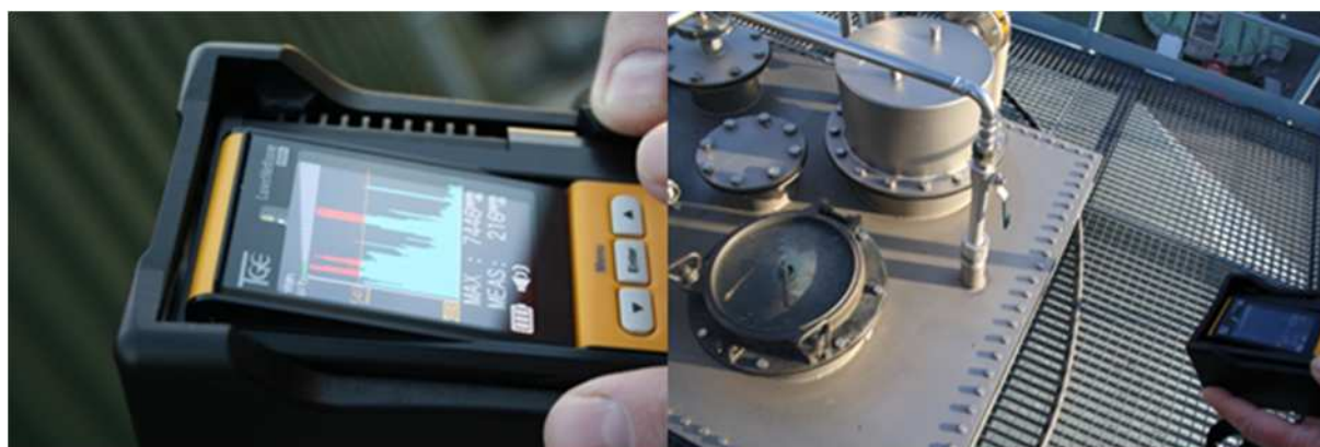
Abb. 3.48: Laserhandmessgerät zur Methanleckortung (links), Vermessung des Kopfteils eines Anaerobreaktors auf einer Kläranlage (rechts) (Bildquellen: Autor)
