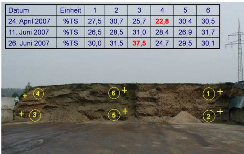
Abb. 10.7: Beprobung eines Fahrsilos mit Maissilage über den Querschnitt und über den Vortrieb (Bildquelle: Wiese und Kujawski [2007] )
