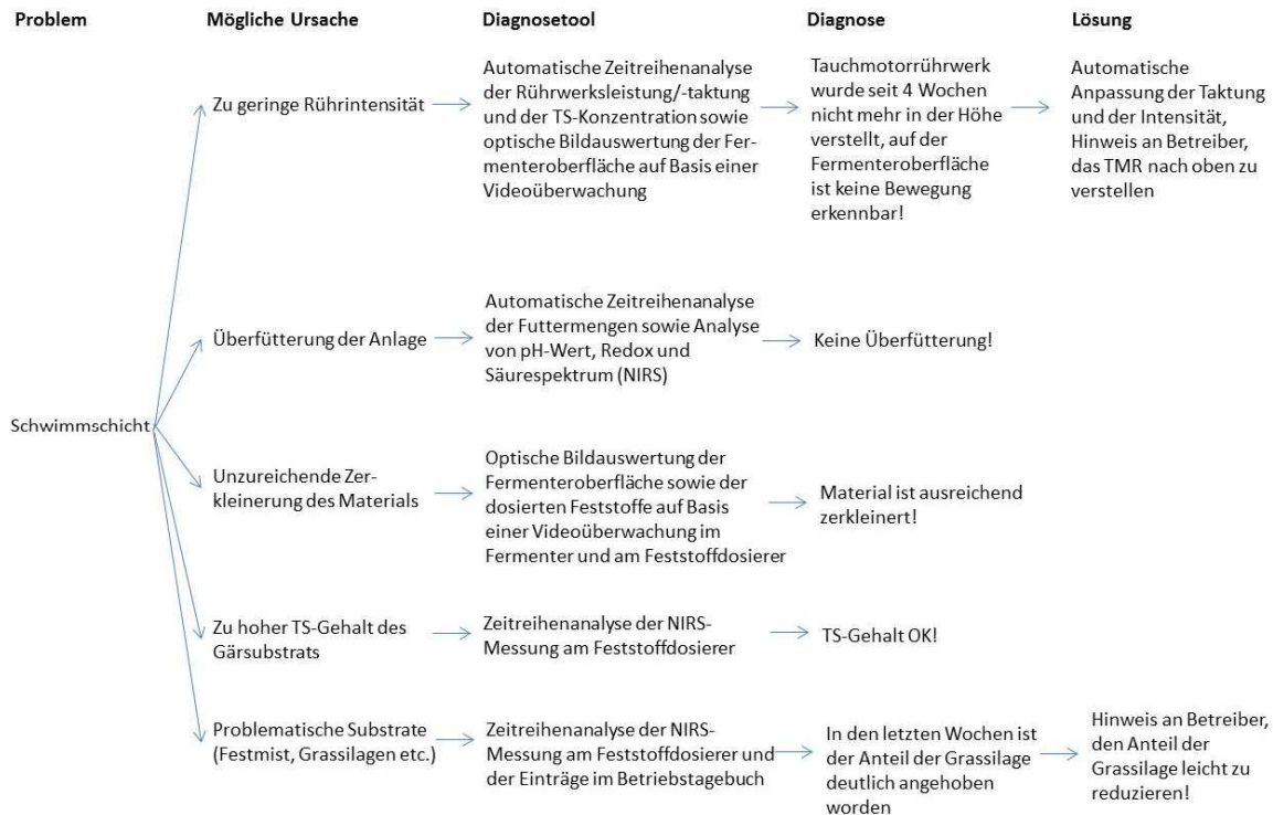
Abb. 10.29: Beispiel für eine mögliche automatisierte Problemdiagnose und geeigneter Lösungsvorschläge am Beispiel der Schwimmschichtproblematik (Quelle: Wiese)
