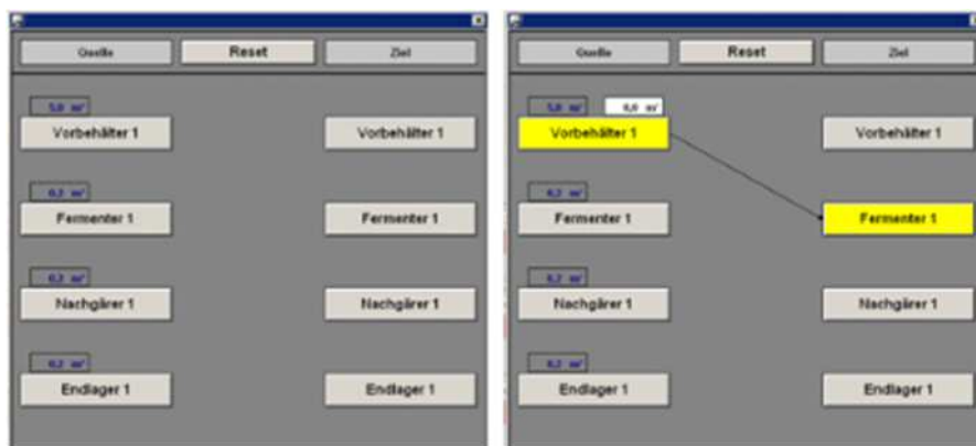
Abb. 10.18: Handbetrieb im Semi-Automatikbetrieb (links: direkt nach Öffnen des Menüs, rechts: nach Eingabe der gewünschten Charge: in diesem Beispiel werden 5 m 3 Substrat von dem Vorbehälter 1 in den Fermenter 1 gepumpt) (Bildquelle: ASA/EnerCess [2005-2008])
