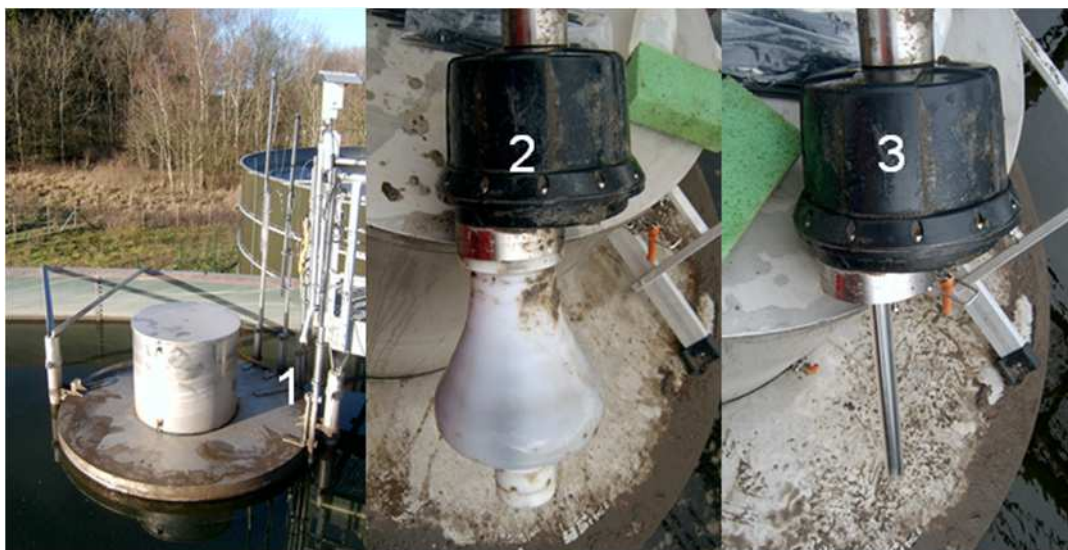
Abb. 3.38: Installation einer VSV-Messsonde (Fa. Hach Lange) in einem SBR (1 = Befestigung der Sonde am schwimmenden Dekanter, 2 = VSV-Messung mit birnenförmigen Sedimentationsgefäß, 3 = Zeilenkamera im Inneren des Sedimentationsgefäß) (Bildquellen: Autor)
