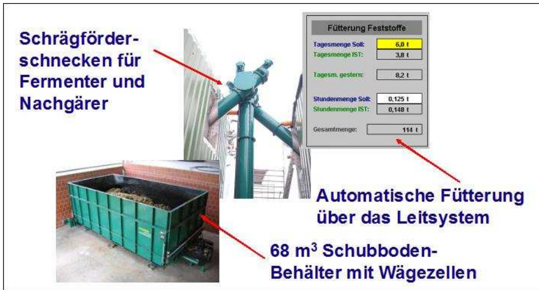
Abb. 10.6: Feststoffdosierer als Schubboden mit horizontalen und vertikalen Förderschnecken sowie 45° Grad-Stopfschnecken (Bildquelle: Autor)
