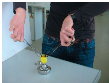
Abb. 5: Kontrolllexperiment: In einer Ballonhaut kann Wasser zum Kochen gebracht werden
