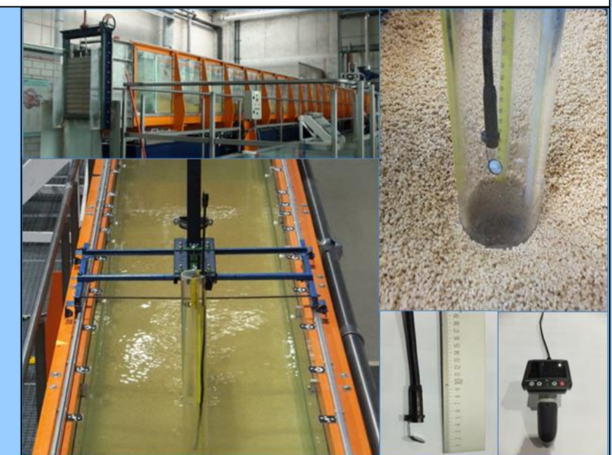
Abb.3: oben: Versuchsrinne, schematisch, rechts: Fotos der Rinne, des Pfeilers und endoskopischen Messsystems
