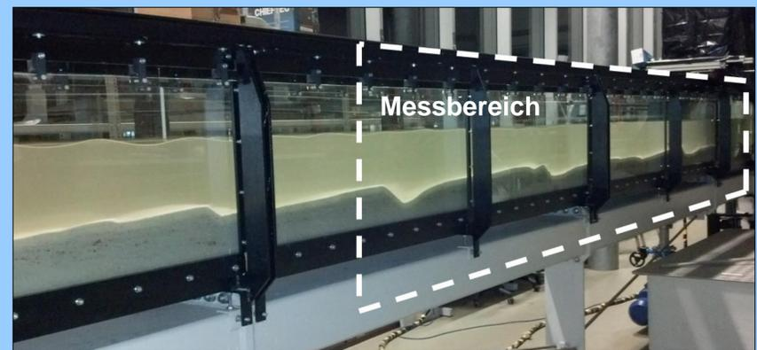
Abb. 6: Versuchsrinne (L x B x H = 10 x 0,3 x 0,5 m)
