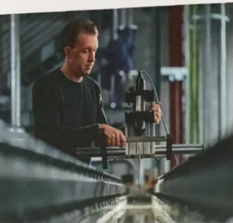
Gute Voraussetzungen für die Bearbeitung seiner Promotion bietet dem Doktoranden Daniel Hesse die wasserbauliche Versuchshalle des Fachbereiches Wasser, Umwelt, Bau und Sicherheit. An einer Versuchsrinne kann er mit entsprechender Messtechnik die Prozesse zum Sedimenttransport untersuchen.
