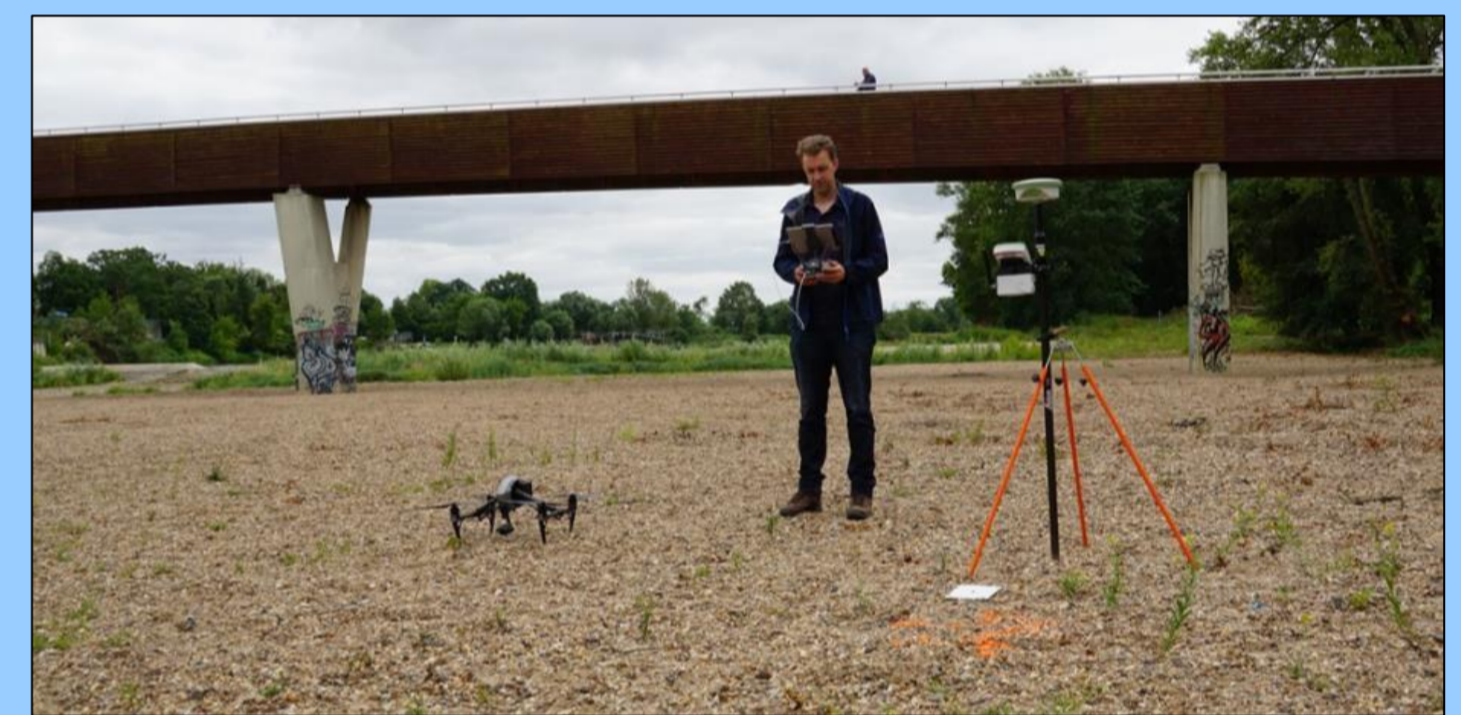
Abb.3: Einsatz der Drohne im Gelände mit beispielhaftem Kontrollpunkt (weiße Plakette) und Prüfpunkt (orange Markierung)
