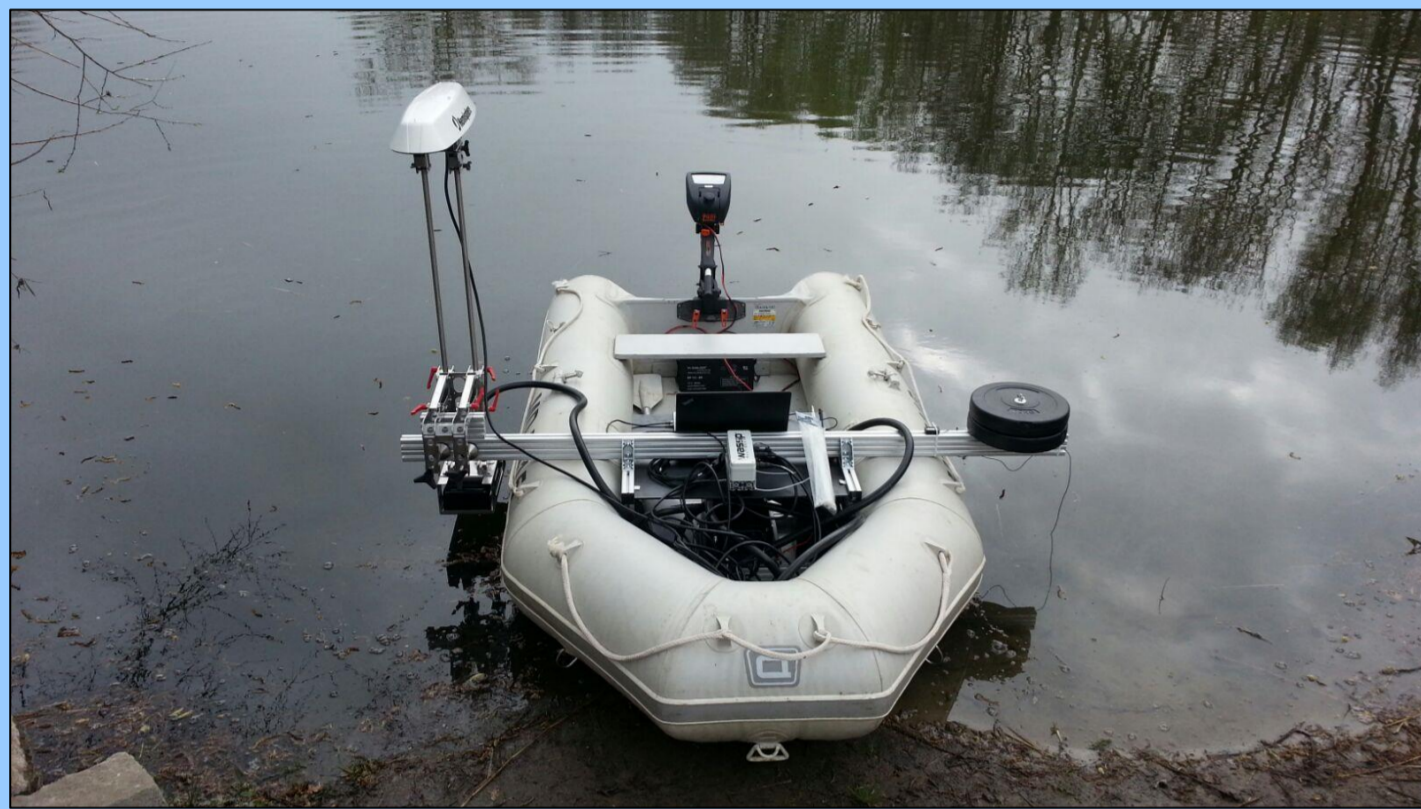
Abb.2: Montage des Fächerecholotes auf einem Schlauchboot
