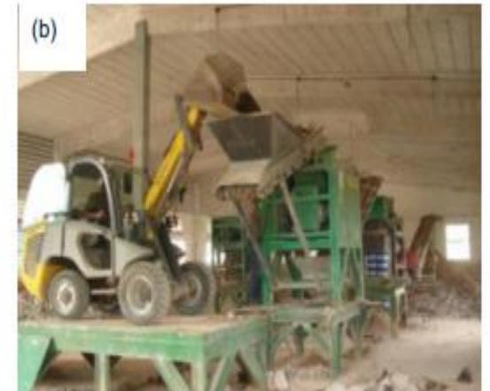
Foto de la nave con los equipos de la planta de reciclaje de áridos atendida por la Oficina del Historiador, (a) vista de equipos, (b) proceso total de reciclaje
